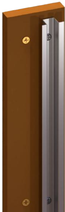
Rastrell 45x19 mm per a muntatge tipus 1 amb omega metàl·lica de 20x25 mm (plenum 40 mm).
